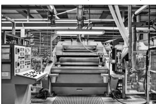
Квадрат от немецкой фирмы Frenzelit. На этом агрегате «прокатываются» прокладочные материалы
